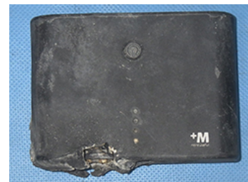
モバイルバッテリーのこげ跡
