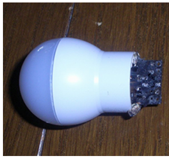
LED照明のこげ跡
